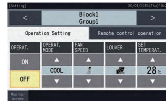
ENCENDIDO / APAGADO, "modo de operación", "velocidad del ventilador", "dirección de Louver oscilante", "temperatura de ajuste" y "prohibición de la operación del control remoto para elementos individuales (marcha / parada, modo de operación, velocidad del ventilador, dirección del louver, ajuste temperatura)"
